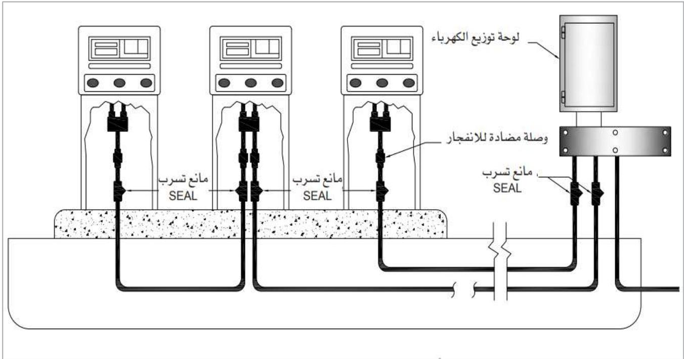
شكل رقم (3-4): تركيب مانع التسرب (SEAL) عند النقاط التي تحمل علامة (S)
