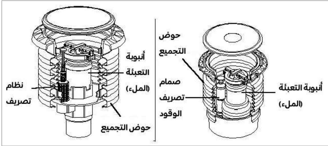
شكل رقم (4-6): استعادة بخار الوقود أثناء عملية ملء خزانات الوقود الأرضية بالوقود
