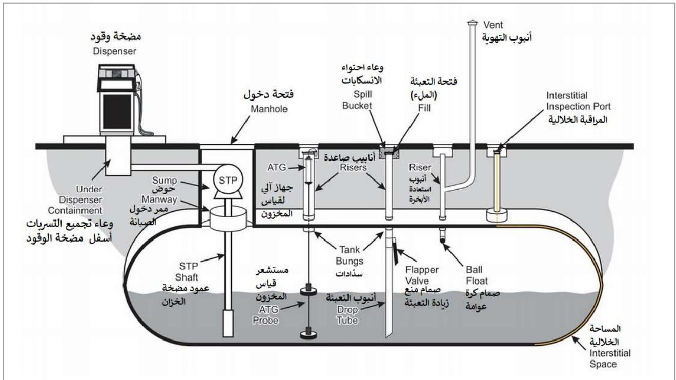
شكل رقم (4-5): وعاء احتواء الانسكابات لفتحة التعبئة (الملاء)
